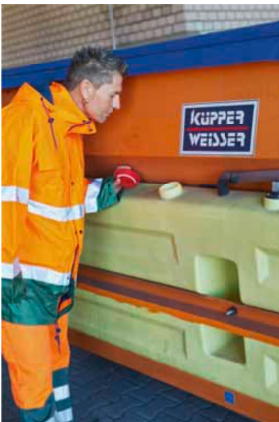
Genug Sole-Lauge im Tank? Arthur Piotrowski öffnet einen Deckel am Streucontainer. Mit Trockensalz bringt die Sole-Lauge fast jedes Eis zum Schmelzen.
